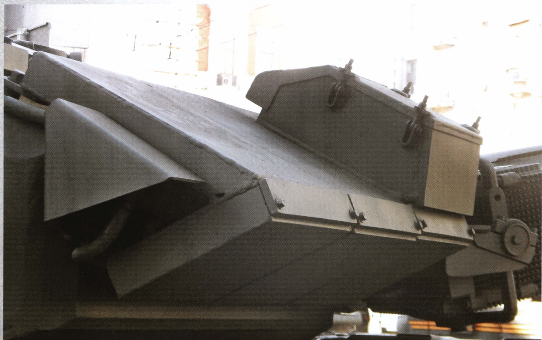
Крепление блоков динамической защиты «Контакт-5» на башне танка Т-90А.
