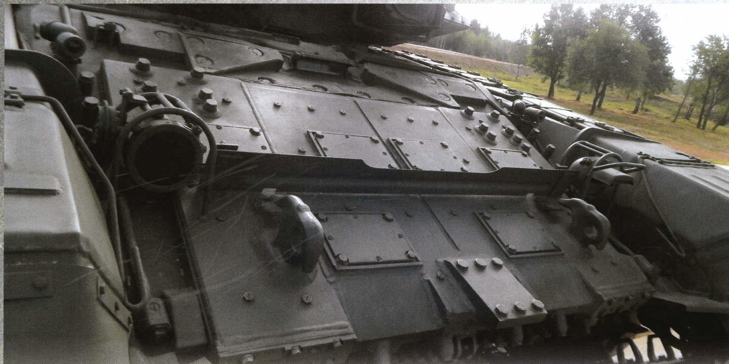
Лобовой лист корпуса танка Т-90А с элементами встроенной динамической защиты «Контакт-5». Хорошо видно, что ее установка отличается от танка Т-80У.
