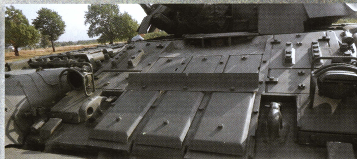
Вид на лобовой лист корпуса танка Т-80У. Хорошо видны элементы встроенной динамической защиты «Контакт-5».
