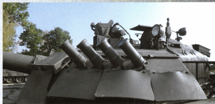
Установка блоков динамической защиты «Контакт-5» на башне танка Т-80У. Сверху на блоках смонтированы дымовые гранатометы.
